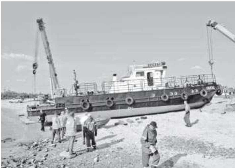
Спуск теплохода на воду после ремонта
