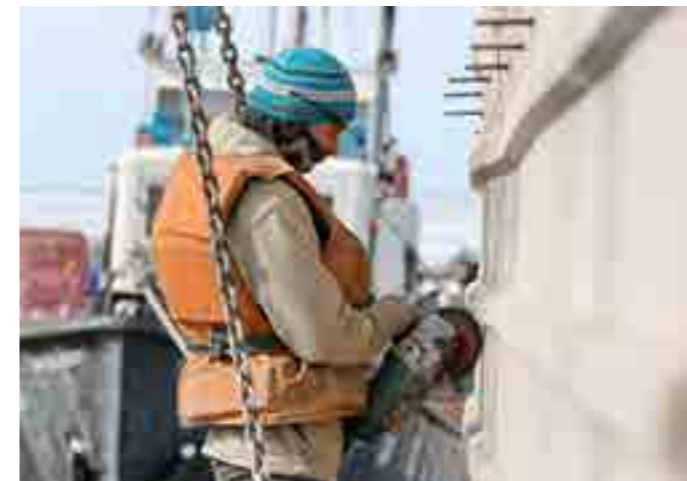
Экипаж «Бухты» прихорашивает свой теплоход: сейчас счищают старую облупившуюся краску, после чего нанесут грунтовку и финишный белый слой
