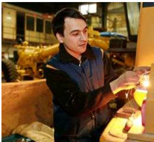
Слесарь по ремонту дорожно-строительных машин и тракторов 4 разряда Константин Потопов производит замену габаритного фонаря
